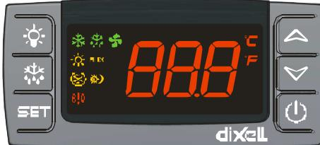
**SET:** отображает значение желаемой установки; в режиме программирования – выбирает параметр или подтверждает операцию.
