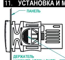
Контроллер XR60CX должен монтироваться на вертикальной панели в вырез 29x71мм и закрепляться, используя поставляемые специальные держатели.
